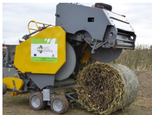
Εικόνα 22. Δυο παραδείγματα καινοτόμων λύσεων για τη συγκομιδή ξυλείας από αγροτικά κλαδέματα που αναπτύχθηκαν μέσω του έργου EuroPruning: ο θρυμματιστής PC50 της ONG-SNC με δυνατότητα εκφόρτωσης σε μεγάλους σάκους, παράλληλα με ρυμουλκό, ή ενσωματωμένο κοντέινερ με σύστημα ανάκλησης κι εκφόρτωσης (αριστερά) - Κυλινδρική χορτοδετική μηχανή PIMR PC50 (δεξιά).
